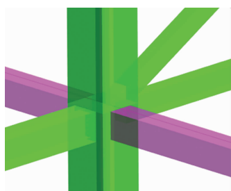
图 25 高塔端刚性连接节点构造示意图
