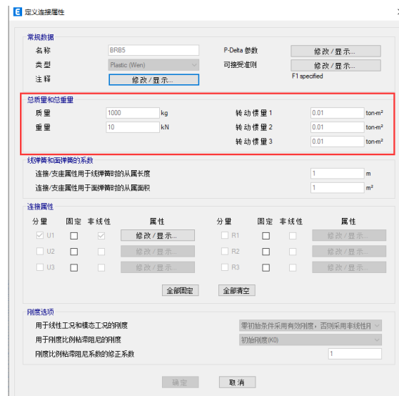
图 6 连接单元质量/重量与转动惯量
