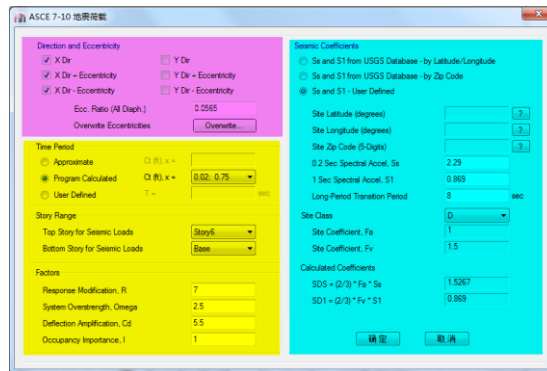
图 3 等效侧向力法地震工况定义
