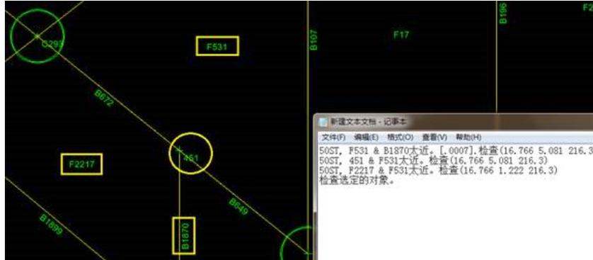
由于程序一般会就同一位置给出多条警告，所以建议通过警告中提示的坐标来定位产生警告的位置。坐标 (16.766, 5.081, 216.3) 是图中 451 号节点。由于 451 号节点在面 F531 的一条边上，但该节点不是 F531 的节点，导致了上图中的第二条警告；基于同样的原因，程序还报出了第一、第三条警告。
