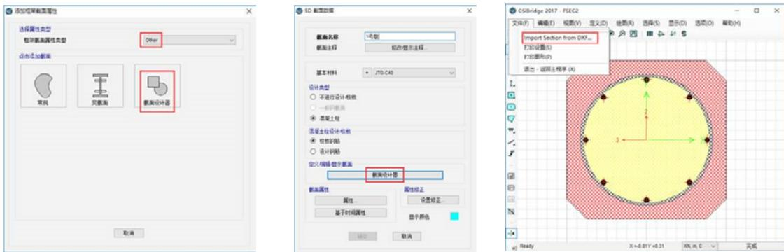
点击 Import Section from DXF 然后可在对话框中选择要导入的 dxf 文件
