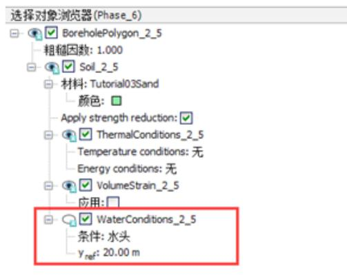
图 1 坑底含水层的水力条件设置
