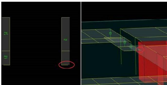
首先根据警告给出的坐标，确定发生警告的位置。从下面的截图可以发现，模型存在两个问题：1) 在悬挑板所在位置，剪力墙未进行切割或剖分；2) 边梁节点与悬挑板节点位置不重合。上述两个原因导致悬挑板角节点刚度为零，该位置处梁、悬挑板、剪力墙的位移不连续。
