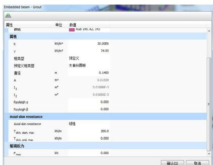
图 1.15 嵌入式梁单元的材料参数
