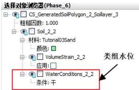
图 2.7 坑内开挖土层的疏干设置
