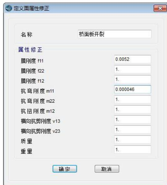
图 2-6 模拟桥面板开裂的刚度修正确定义窗口
