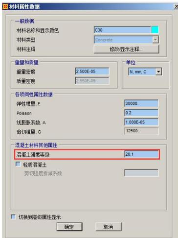
图 5 SAP2000 V17 混凝土材料属性数据
