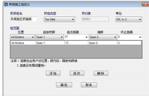
图 2-5 负弯矩区桥面板结构组设置
