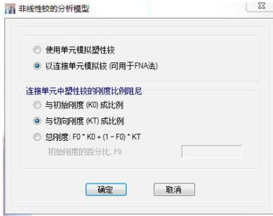
图5 设置非线性较的分析模型对话框
