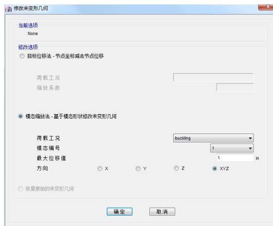
图 6 修改未变形几何模拟初始缺陷
