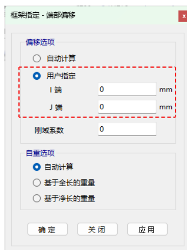
图 5 取消端部偏移长度
