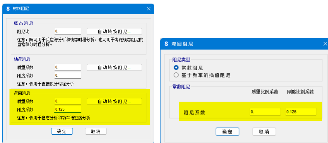
图 2 材料定义中的滞回阻尼 vs 荷载工况中的滞回阻尼
