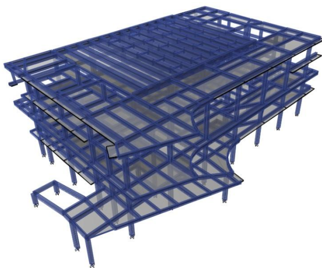
图 1 混凝土框架结构模型
