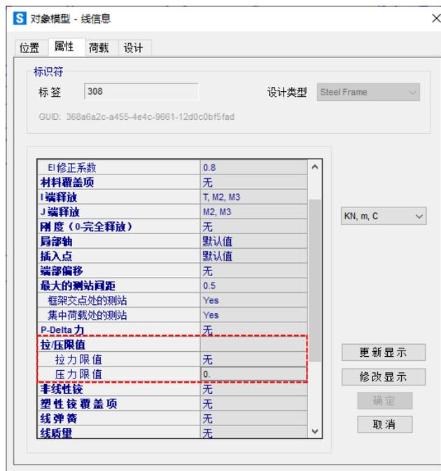
图 4 单拉支撑的拉/压限值
