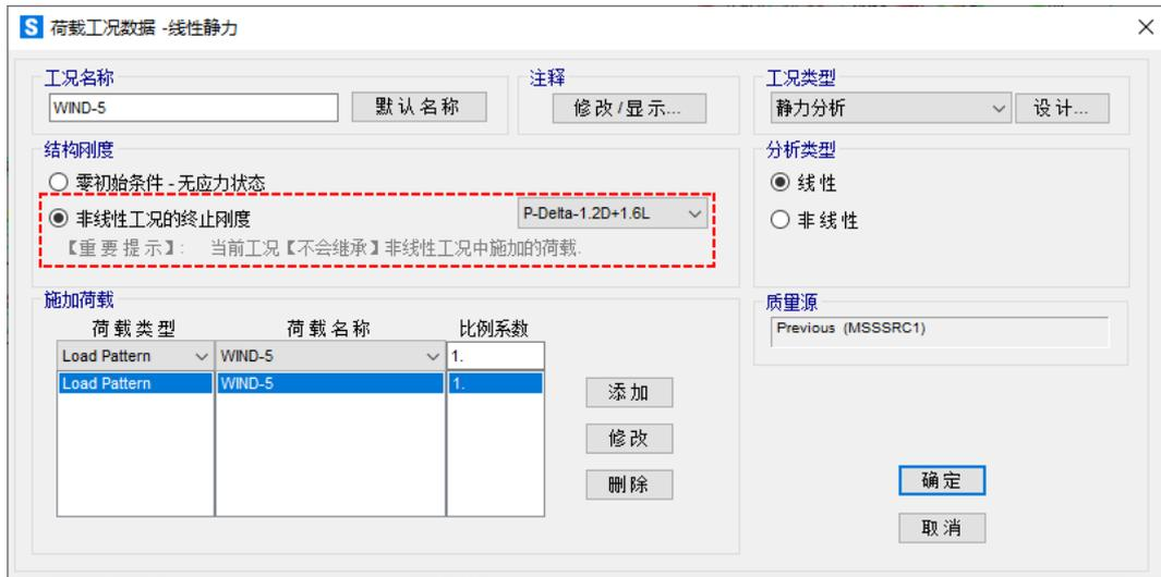
图 3 风荷载工况的定义
