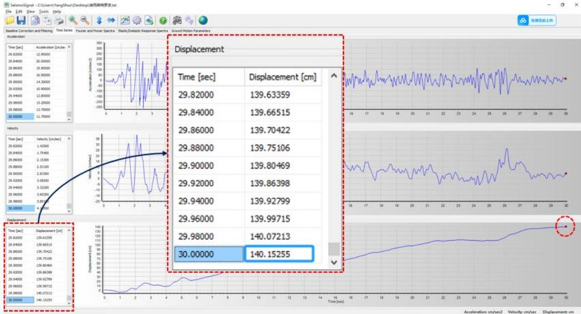
图 3 EL Centro 地震波积分结果 (SeismoSignal 软件)
