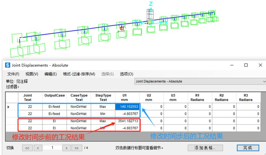
图5 节点绝对位移（修改前 vs 修改后）
