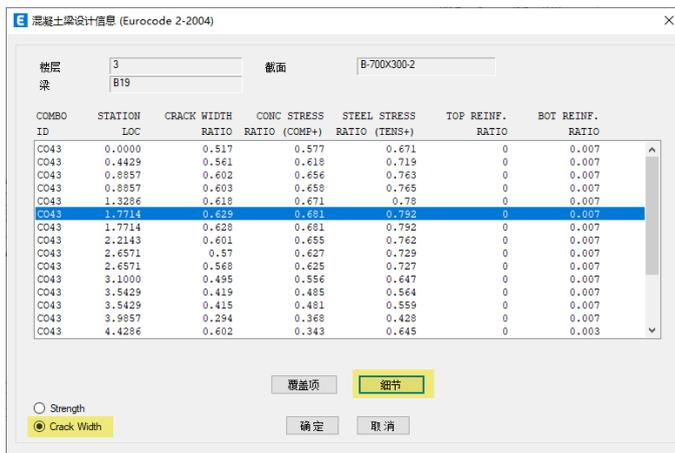
图 6 ETABS 混凝土梁设计信息（Crack Width）
