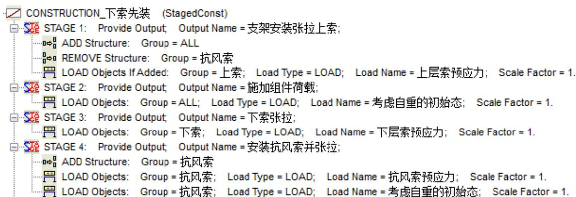
图 2 CONSTRUCTION 阶段施工工况定义
