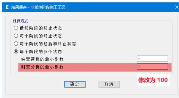
图 3 修改施工阶段中时变分析的增量步数
