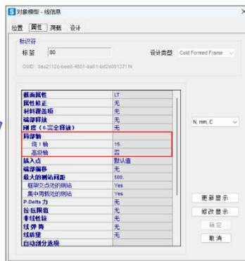
图9 檩条绕框架局部1轴旋转15度
