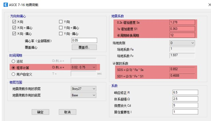
图 2 x 方向地震作用输入界面
