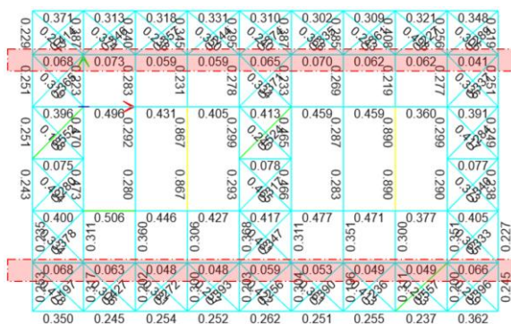
图 6 修正后的屋面水平构件应力比
