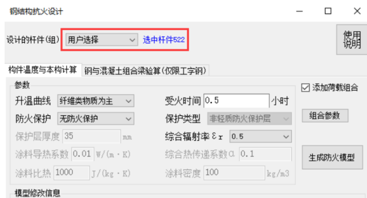
图 3 选择构件并输入计算参数
