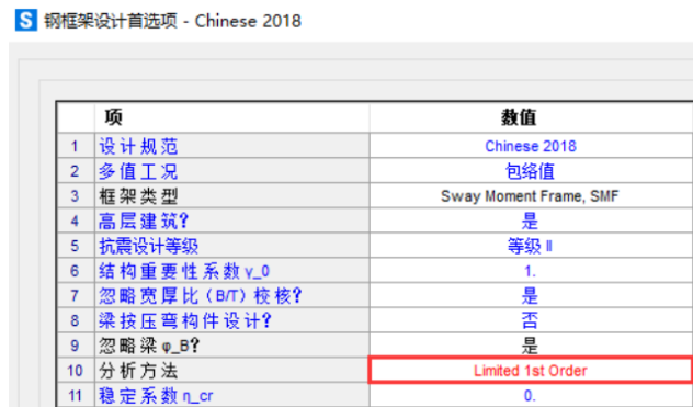
图 2 钢结构防火设计采用一阶方法
