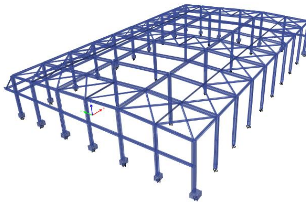
图 1 某单层钢框架结构模型图
