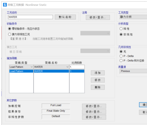
图3 地下水工况设置界面
