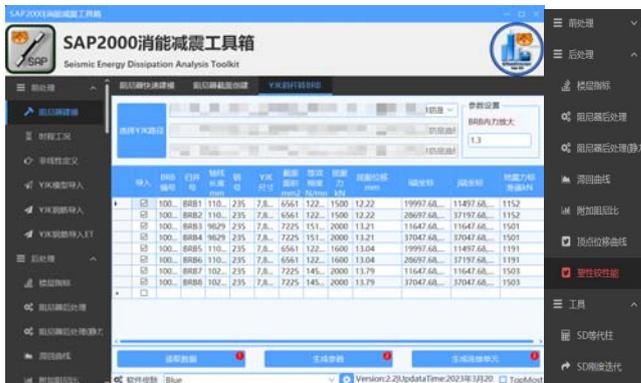
图 4 读取 YJK 模型等代杆生成 SAP2000 连接单元图
