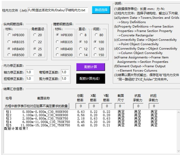
图 4 消能子结构柱及隔震支墩 PM 配筋功能界面
