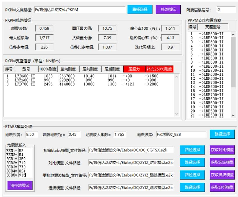
图 2 PKPM/YJK 到 ETABS 模型转换功能界面
