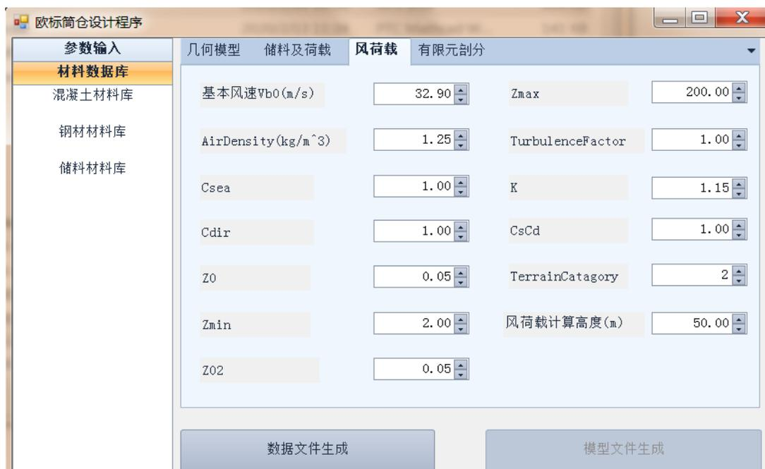
图 1-3 欧标筒仓设计程序 EuroSilo 界面-风荷载
