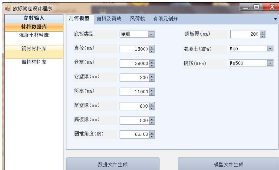
图 1-1 欧标筒仓设计程序 EuroSilo 界面-几何建模
