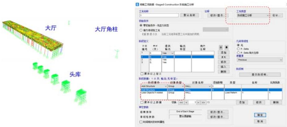
图 5 SAP2000 阶段施工模拟分析
