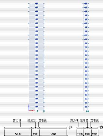
图 2 墙肢变形与阻尼器变形关系（一）
