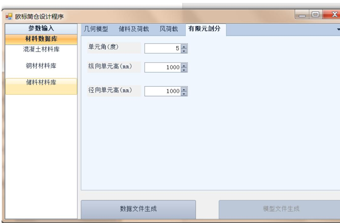
图 1-4 欧标筒仓设计程序 EuroSilo 界面-有限元剖分
