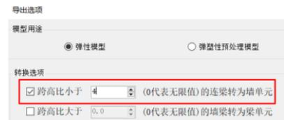
图 14 筑信达 DC 中的连梁转换选项
