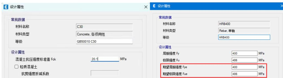
图 1 混凝土材料与钢筋材料强度属性输入
