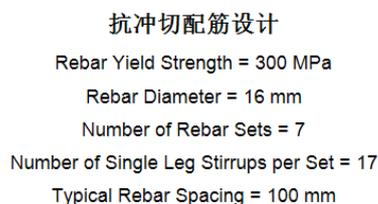
图 12 冲切钢筋输出细节
