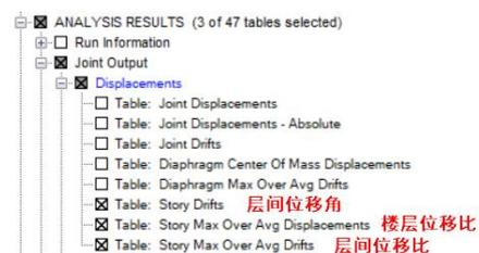
图 29 ETABS 输出的位移指标
