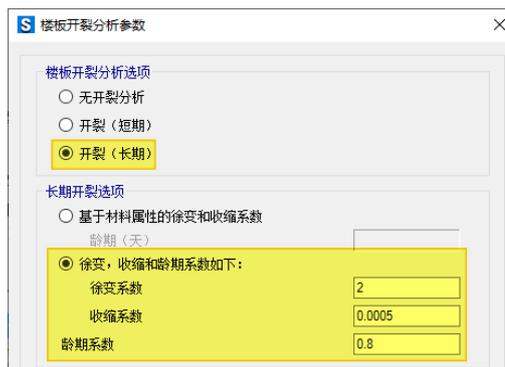
图 13 楼板长期开裂参数设置
