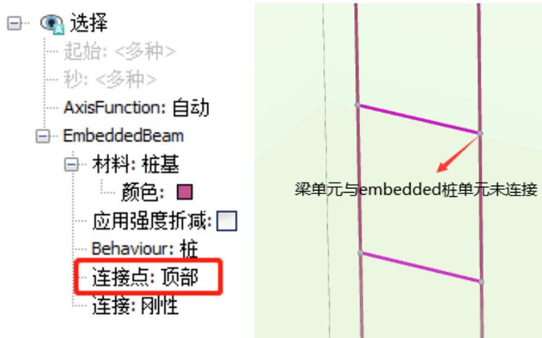
图3 结构连接属性图
