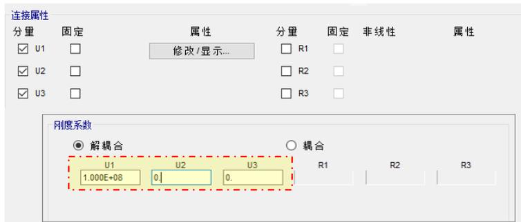
修改后，支座 linear 连接单元的设置
