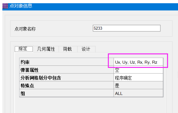
图 4 筏板上的所有节点指定为固端约束
