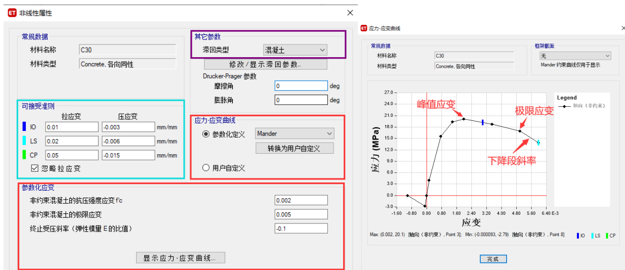
图6 材料非线性属性定义（以混凝土为例）
