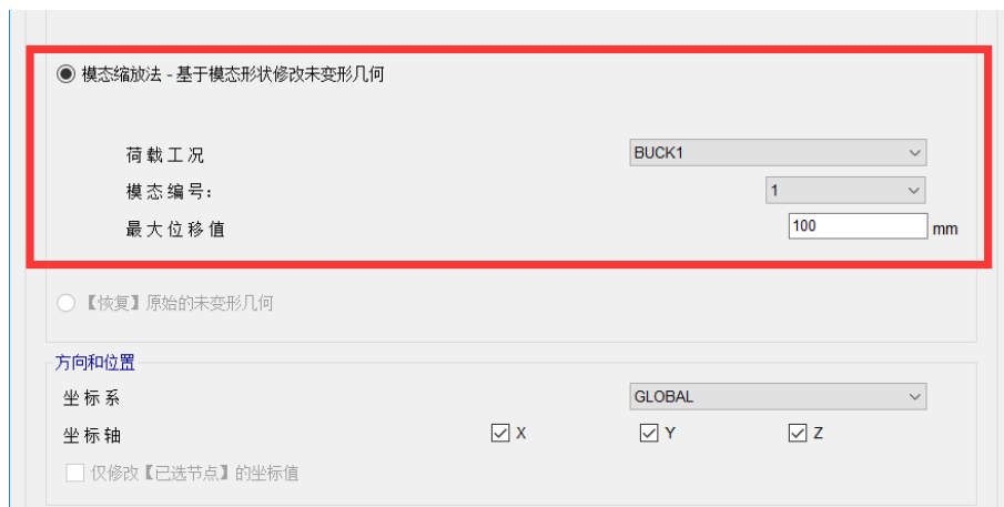
图 5 施加结构初始缺陷
