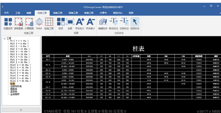
柱平法施工图-列表注写
