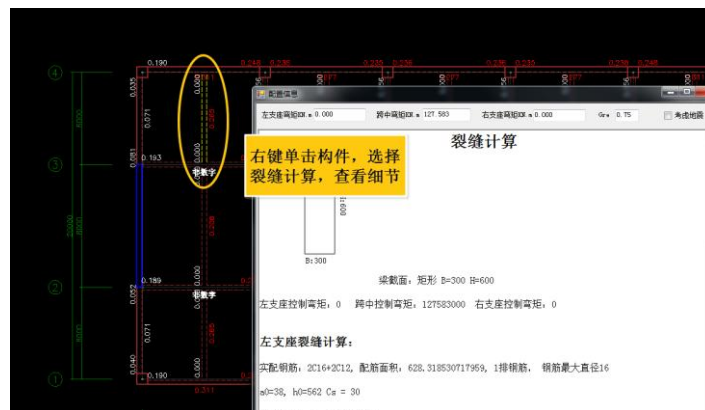
(b) 裂缝验算过程
