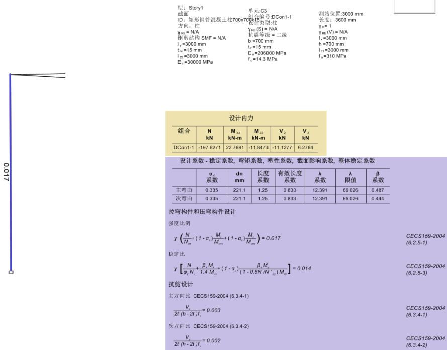
图 3 矩形钢管混凝土柱设计细节
