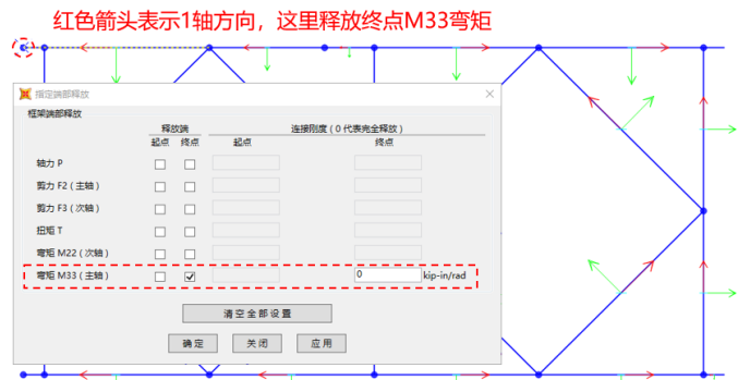
图 4b 贝雷梁内杆件的连接
