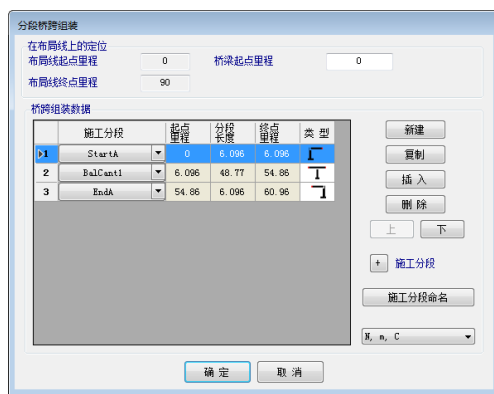
图 2 “分段桥梁组装”窗口
