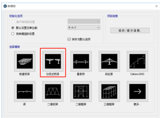
图 1 新建分段桥梁窗口
