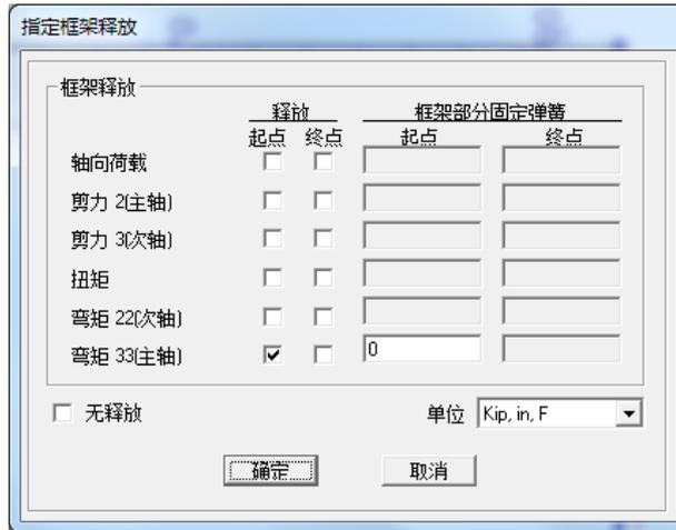
SAP2000 中的端部释放功能，除完全刚接外还可以实现部分刚接，只需指定非零的弹簧刚度即可。另外，在对构件的两端同时指定端部释放时，应注意避免造成不稳定的端部释放，如：
