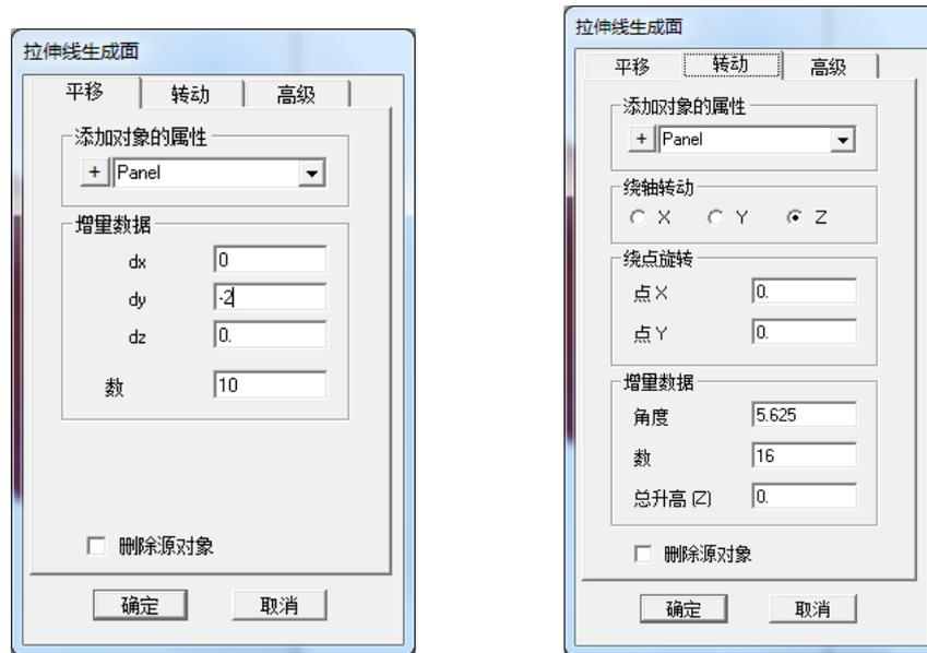
图 3-3 拉伸线成面（左图为平移，右图为转动）
