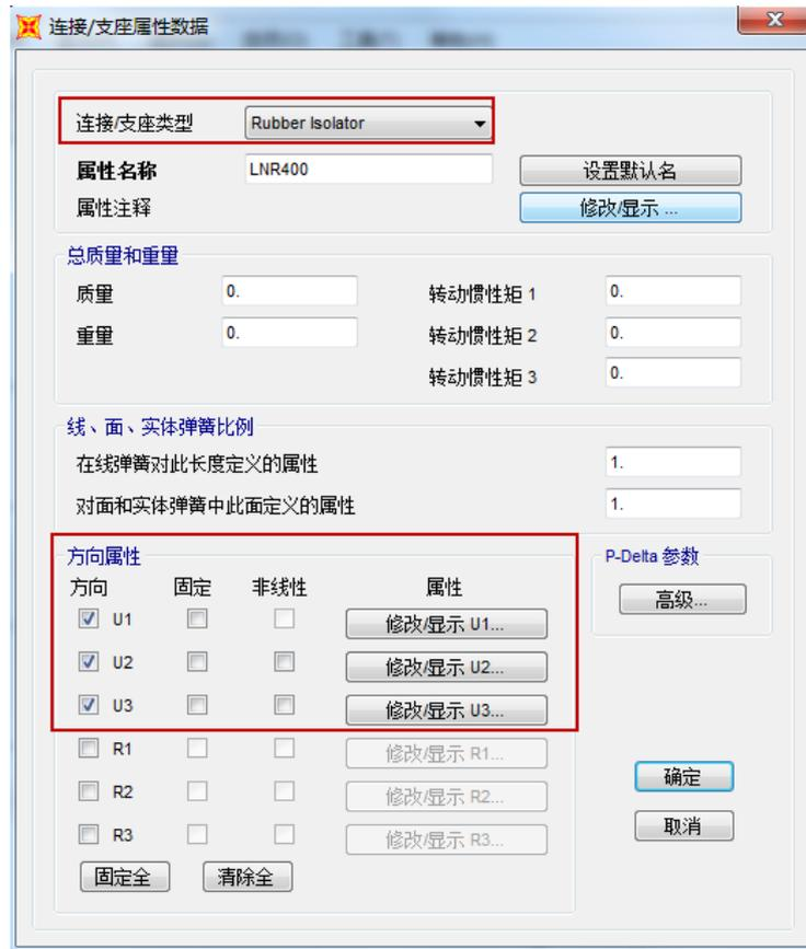
图 3-6 隔震支座参数含义
