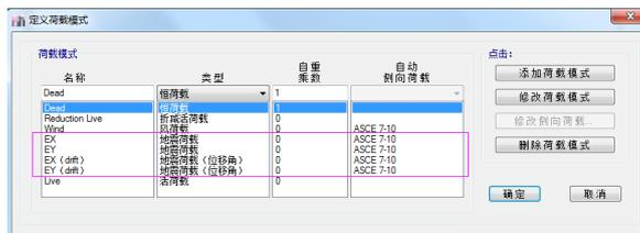
图 7 关于地震工况的荷载模式类型
