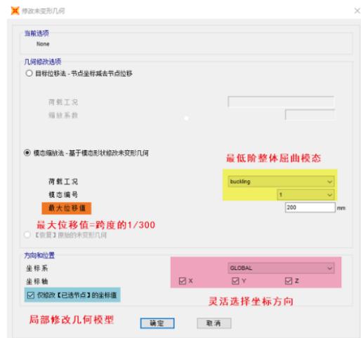
图 2 初始几何缺陷施加
