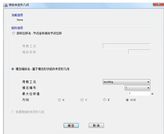
图 6 修改未变形几何模拟初始缺陷
