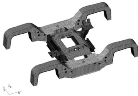
上海地铁 1 号线车辆转向架寿命预测数值分析<sup>1</sup>
