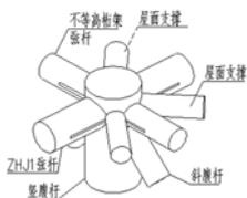
主桁架上弦节点轴测图
